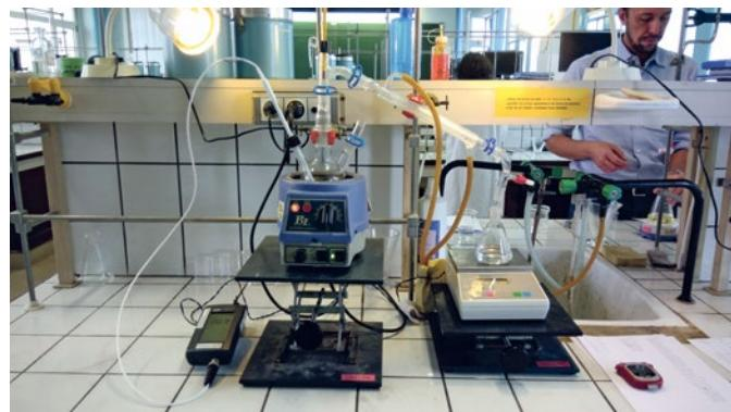
Cette expérience est simple à réaliser si le montage d'hydrodistillation est mis en place par le personnel technique du laboratoire. Il est nécessaire d'utiliser une balance branchée sur secteur pour éviter qu'elle s'éteigne lors de l'expérience.
