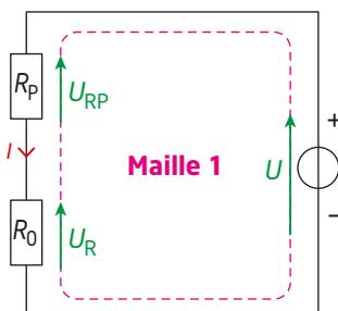
Dans la maille 1 comprenant le générateur idéal de tension  $U$ , la photorésistance  $R_p$  et la résistance  $R$  :
