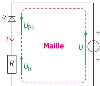
La loi des mailles donne :  $U - U_R - U_{ph} = 0$  soit  $U_R = U - U_{ph}$ . D'après la caractéristique de la photodiode pour un éclairement  $E_1$  sans fumée, l'intensité du courant qui traverse la photodiode est quasiment nulle quelle que soit la tension, donc la tension  $U_1$  aux bornes de la résistance  $R$  est quasiment nulle car  $U_1 = R \times I_1 = R \times 0 = 0$  V.
