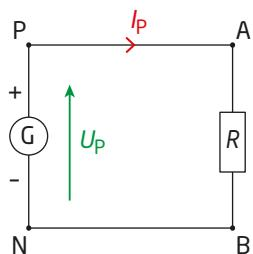
L'intensité commune du courant traversant le générateur et la résistance R vaut :  $I_p = 1,0 \times 10^{-3} \text{ A}$ .
