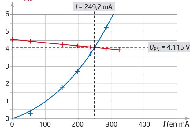
Les coordonnées du point de fonctionnement sont  $I_p = 249 \text{ mA}$  et  $U_p = 4,12 \text{ V}$ .
