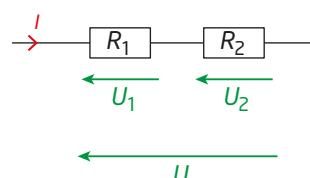
d. La loi d'additivité des tensions associée à la loi d'Ohm donne :  $U = U_1 + U_2 = R_1 \times I + R_2 \times I = (R_1 + R_2) \times I$ .
