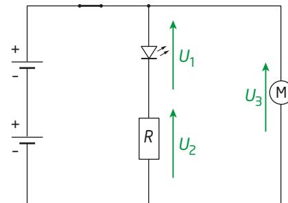
b. Pour pouvoir calculer la tension  $U_2$ , il faut représenter les tensions aux bornes des deux piles :
