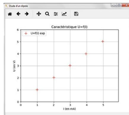
b. Les points représentant la tension  $U$  en fonction de l'intensité  $I$  aux bornes du dipôle AB sont au voisinage d'une droite passant par l'origine; il y a donc proportionnalité entre ces deux grandeurs. Les lignes 21 à 37 sont donc complétées pour proposer une modélisation linéaire de la caractéristique :
