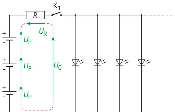
b. La loi des mailles dans la maille 1 s'écrit :  $U_p + U_p + U_p - U_R - U_G = 0$ . L'interrupteur étant ouvert, l'intensité du courant est nulle dans la résistance R et la tension  $U_R$  est nulle également. On a donc :  $3 \times U_p - U_G = 0$   $U_G = 3 \times U_p$ . A.N. :  $U_G = 3 \times 1,5 \text{ V} = 4,5 \text{ V}$ .
