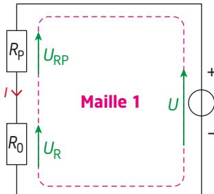
Dans la maille comprenant le générateur idéal de tension  $U$ , le capteur de force de résistance  $R_c$  et la résistance  $R_0$ , on a :
