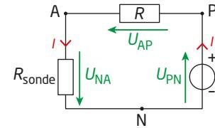
$$U_{PN} + U_{NA} + U_{AP} = 0 \text{ soit, avec } U_{AP} = -U_R \text{ et } U_{NA} = -U_{sonde}, U_g - U_R - U_{sonde} = 0.$$
